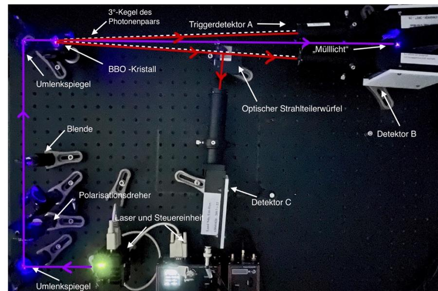
Einzelne Photonen der Wellenlänge  $\lambda = 405 \text{ nm}$  erzeugen in einem doppelbrechenden beta-Bariumoxid Kristall (BBO) gleichzeitig zwei Photonen doppelter Wellenlänge. Eines wird im Triggerdetektor A nachgewiesen, der für 5ns die beiden anderen Detektoren „scharf“ schaltet. Das andere Photon wird am Detektor B oder C nachgewiesen, aber nie an beiden gleichzeitig (koinzident), es teilt sich also nicht auf.
