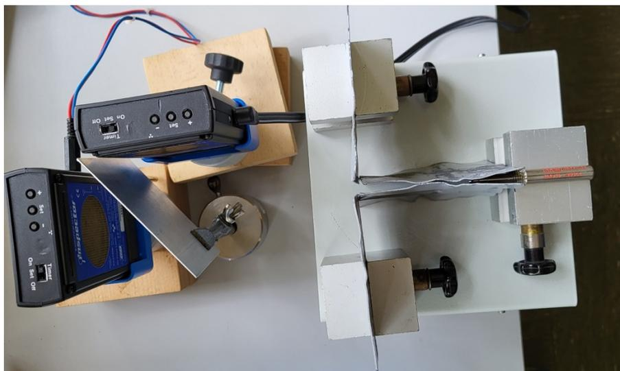
Durch Bleiplatten wird die Strahlung eines radioaktiven Strahlerstiftes (hier Sr90) auf einen kleinen Winkelbereich eingeschränkt. Die Strahlung trifft auf eine Aluminiumplatte, die hier als Strahlteiler dient. Die transmittierte und die reflektierte Strahlung wird jeweils von einem Großflächenzählrohr registriert.
