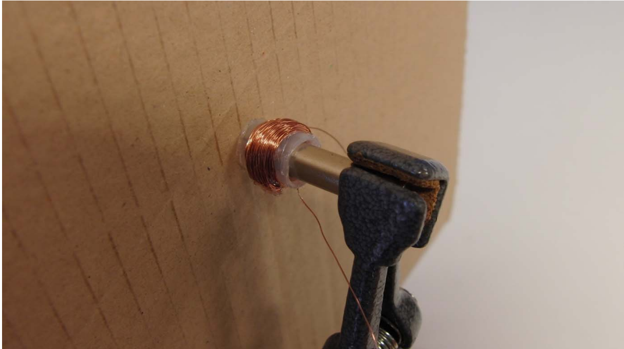
Wellpappenmikrofon von hinten (Spule auf Wellpappe und feststehender Magnet) Das Ende des Magneten ist in der Spulenmitte.
